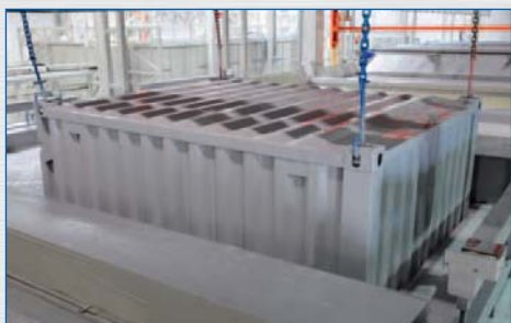
KTL-grundiranje potapanjem u bazenima
